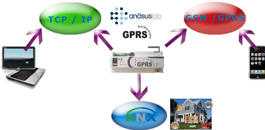
Las principales funciones del módulo GPRS KoNeXion (entre otras) es permitir al usuario e integrador establecer una comunicación bidireccional con una instalación domótica KNX desde una ubicación remota, mediante:
