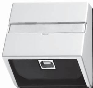
Die USB-Schnittstelle dient zur Ankopplung eines PC mithilfe einer USB-Datenleitung an den EIB / KNX. Die USB-Schnittstelle wird auf einen Busankoppler UP aufgesetzt. Sie kann innerhalb des Systems an einer beliebigen Stelle integriert werden.
