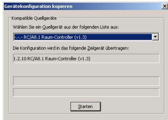
→ Nach dem Anklicken des Abwärtspfeils werden sämtliche im Projekt vorhandenen Raum-Controller angezeigt und können zur Konvertierung einzeln ausgewählt werden.
