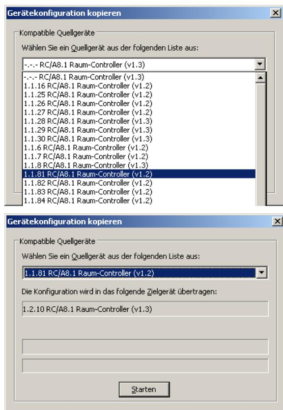
→ Nach der Konvertierung („Starten“) enthält der neue Raum-Controller sämtliche Daten des ausgewählten Raum-Controllers. Der alte Raum-Controller kann danach gelöscht werden.
