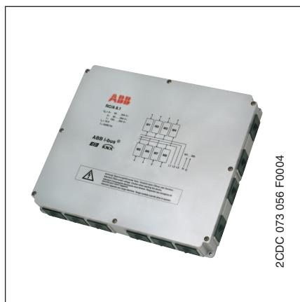
Das Raum-Controller-Grundgerät RC/A 8.1 nimmt bis zu 8 steckbare Module auf. Es steuert deren Funktion und kommuniziert als ein Busteilnehmer über ABB i-bus® EIB / KNX. In jeden Steckplatz kann ein beliebiger Modultyp eingesteckt werden. Das eingesteckte Modul wird automatisch erkannt und mit der Versorgungsspannung und Einspeisespannung verbunden. Die Handbedieneinrichtung erlaubt den sofortigen Funktionstest, auch ohne anliegende Busspannung.
