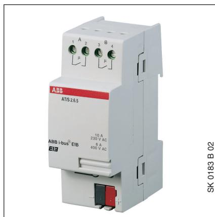
Der 2fach Schaltaktor ist ein Reihen-einbaugerät zum Einbau in Verteiler. Die Verbindung zum EIB wird über eine Busanschlussklemme hergestellt. Der Aktor benötigt keine zusätzliche Stromversorgung.
