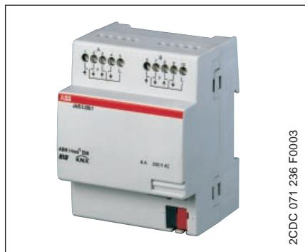
Der Jalousieaktor JA/S 2.230.1 dient zum Steuern von zwei voneinander unabhängigen Gruppen mit jeweils maximal zwei 230 VAC-Antrieben zum Positionieren von Jalousien, Rollläden, Markisen und anderen Behängen sowie zum Steuern von Türen, Fenstern und Lüftungsklappen.
