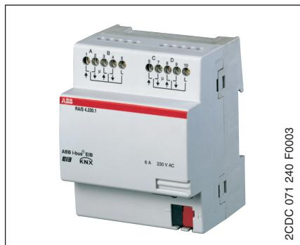
Der Rollladenaktor RA/S 4.230.1 dient zum Steuern von maximal vier voneinander unabhängigen 230 V AC-Antrieben zum Positionieren von Jalousien, Rollläden, Markisen und anderen Behängen sowie zum Steuern von Türen, Fenstern und Lüftungsklappen.
