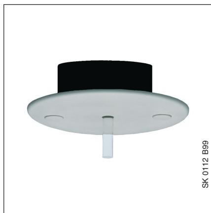
Mit dem Lichtfühler kann in geschlossenen Räumen die Helligkeit ermittelt werden. Die Installation des Lichtfühlers erfolgt in einer Standard-Installationsdose in der Decke. Die Abdeckung (weiß) des Fühlers wird am Fühler festgeklebt. Die komplette Einheit wird in eine Unterputz-Dose verschraubt.
