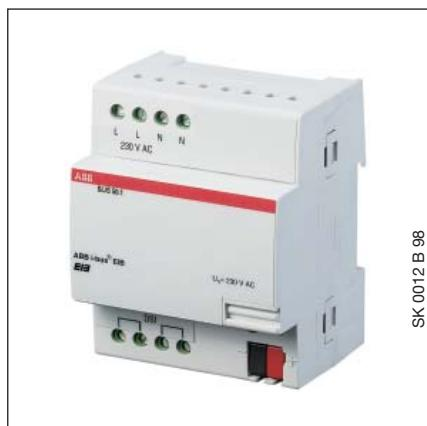
Das Steuergerät ist ein Reiheneinbaugerät zum Einbau in Verteiler. Es dient der Ansteuerung von digital dimmbaren elektronischen Vorschaltgeräten bzw. Transformatoren über den EIB / KNX.
