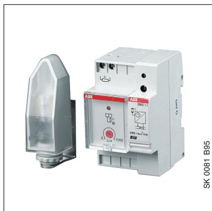
Der Dämmerungsschalter ist ein Reiheneinbaugerät zum Einbau in Verleiter. Die Verbindung zum EIB wird über die Datenschiene hergestellt. Der Lichtsensor zur Erfassung der Beleuchtungsstärke wird über zwei Schraubklemmen angeschlossen.
