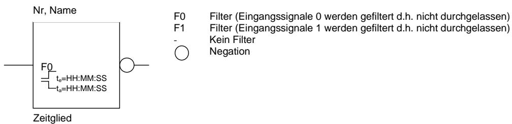
Ein Zeitglied besteht aus einem Eingang und einem Ausgang sowie einer Zeitverzögerung für Objektwerte. Des Weiteren kann ein Filter definiert werden.
