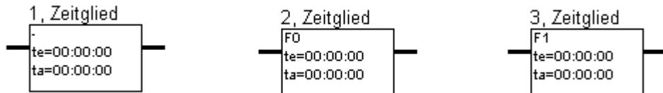
Das Zeitglied verhält sich in einer Funktionskette, deren Ausgang so parametriert ist, daß er bei jeder Zuweisung eines neuen Objektwertes, in gleicher Weise wie ein Tor.
