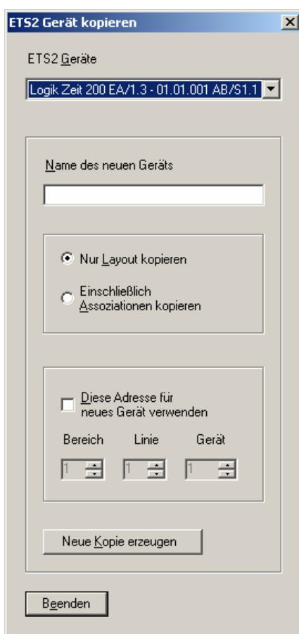
Selektieren Sie zur vollständigen Übernahme der Parametrierung "Einschließlich Assoziationen kopieren" und betätigen Sie die Schaltfläche "Neue Kopie erzeugen".
