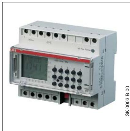
Die 4fach Jahresschaltuhr mit Tages-, Wochen- und Jahresprogramm ist ein Reiheneinbaugerät zum Einbau in Verteiler. Die Verbindung zum EIB / KNX erfolgt über die Busanschlussklemme an der Frontseite.
