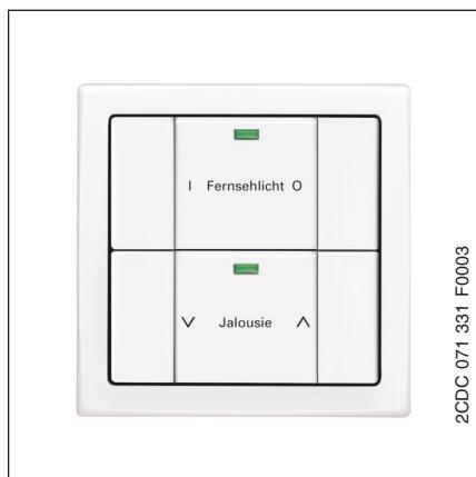
Das Anwendungsmodul 2fach Tastsensor solo® wird auf einen Busankoppler UP, Schaltaktor UP oder Schalt-/Dimmaktor UP aufgesetzt.
