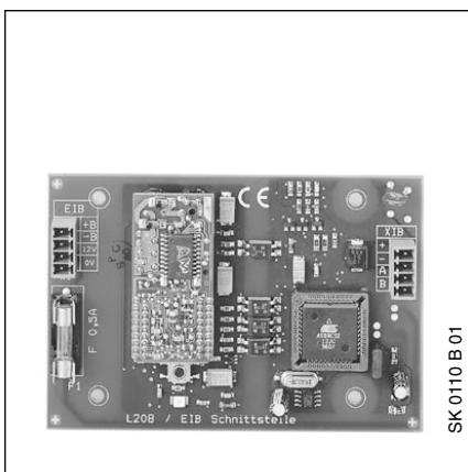
Die L208/EIB-Schnittstelle ermöglicht eine bidirektionale Kommunikation zwischen einer EIB-Installation und einer Einbruchmelderzentrale L208. Durch können professionelle Sicherheitsfunktionen in die Gebäude-Systemtechnik integriert werden.
