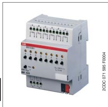
Der 8fach Binäreingang BE/S 8.230.1 mit manueller Bedienung ist ein Reiheneinbaugerät zum Einbau in den Verteiler. Das Gerät ist zum Erfassen von 0...265 V AC/DC-Signalen geeignet. Die Eingänge sind unabhängig.
