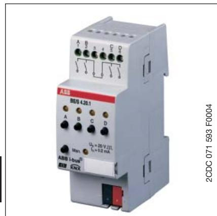
Der 4fach Binäreingang BE/S 4.20.1 mit manueller Bedienung ist ein Reiheneinbaugerät zum Einbau in den Verteiler. Das Gerät ist zum Erfassen von potenzialfreien Kontakten geeignet. Die gepulste Abfragespannung wird intern erzeugt.
