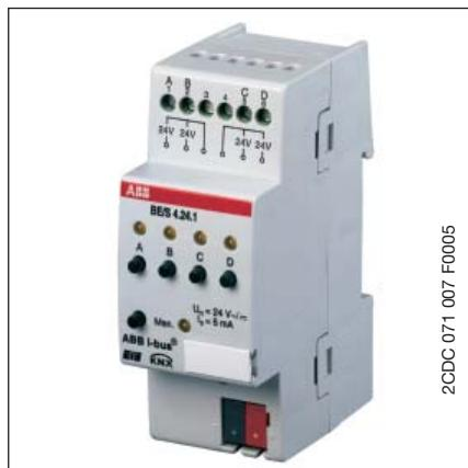
Der 4fach Binäreingang BE/S 4.24.1 mit manueller Bedienung ist ein Reiheneinbaugerät zum Einbau in den Verteiler. Das Gerät ist zum Erfassen von 0...32 V AC/DC-Signalen geeignet. Die Eingänge A und B sind von den Eingängen C und D unabhängig.
