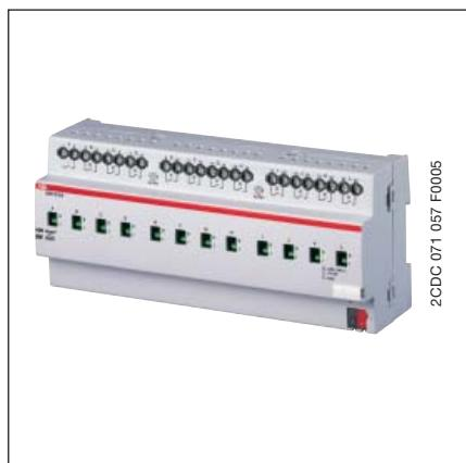
Die 16A-Schaltaktoren sind Reihen-einbaugeräte im proM Design für den Einbau in Verteiler auf einer 35 mm Tragschienen. Die Verbindung zum ABB i-bus® EIB / KNX erfolgt über Busanschlussklemme.
