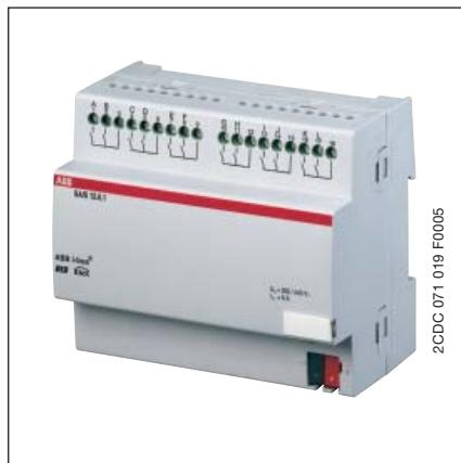
Die 6A-Schaltaktoren sind Reiheneinbaugeräte im proM Design für den Einbau in Verteiler auf einer 35 mm Tragschiene. Die Verbindung zum ABB i-bus® EIB / KNX erfolgt über Busanschlussklemme.
