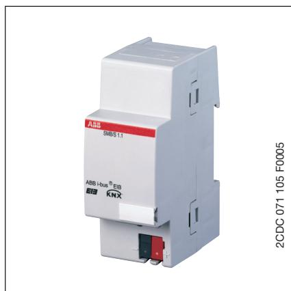
Der Störmeldebaustein SMB/S 1.1 erfasst Informationen, z.B. Störmeldungen, aus der EIB / KNX Anlage und bildet daraus die Ansteuersignale für optische und akustische Meldungen nach DIN 19235.
