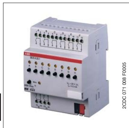
Der 8fach Binäreingang BE/S 8.20.1 mit manueller Bedienung ist ein Reiheneinbaugerät zum Einbau in den Verteiler. Das Gerät ist zum Erfassen von potenzialfreien Kontakten geeignet. Die gepulste Abfragespannung wird intern erzeugt.
