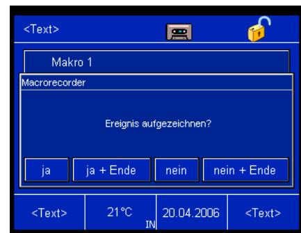
Im Modus „Makros abspeichern“ zeigt das Panel nach jeder ausgeführten Funktion ein Dialog an, in dem der Anwender festlegen kann, ob er diese eben ausgeführte Funktion im Makro abspeichern will oder nicht. Gleichzeitig kann er in demselben Dialogfenster die Makrospeicherung abschließen. Es können bis zu 20 Funktionen in einem Makro abgelegt werden.
