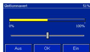
Wird die Touchfläche Gleitkommawert betätigt zeigt das Raumpanel® im sich öffnenden Fenster einen Schieberegler und drei Schaltflächen an. Über den Schieberegler können Werte intuitiv durch Verschiebung des Reglerknopfes eingestellt werden. Über die Schaltflächen lässt sich der Wert, je nach Einstellung, erhöhen bzw. absenken. Die Werte werden direkt während der Bedienung des Schiebereglers gesendet.
