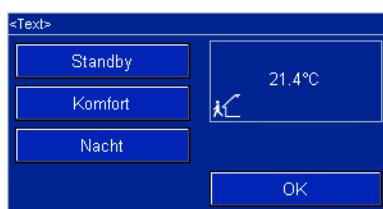
Da die Raumtemperaturregler-Touchfläche eine aktive Schaltfläche ist, öffnet sich nach Betätigung ein Fenster mit drei weiteren Schaltflächen „Standby“, „Komfort“ und „Nacht“. Jede dieser drei Schaltflächen besitzt standardmäßig ein 1-Bit-Kommunikationsobjekt. Die Objekte „Komfort/Standby“, „Nacht“ und „Frost-/Hitze- schutz“ werden über jeweils eine Gruppenadresse mit den gleichnamigen Objekten eines Raumtemperaturreglers verbunden.
