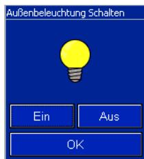
Sofern es sich um eine „Aktive“ Schaltfläche handelt, öffnet ein Fenster bei Betätigung der Touchfläche. In dem Fenster erscheint der „Name der Schaltfläche“ als Überschrift. Die Schaltflächen (hier mit „Ein“ und „Aus“ bezeichnet) können mit einem freien Text beschrieben werden oder Symbole annehmen. Dieser Bedienmodus ist standardmäßig eingestellt (Parameter „Bedienung“ „über Pop-Up“ Fenster).
