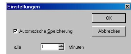
Wenn Sie den Menüpunkt „Einstellungen“ unter Datei aufrufen, können Sie die Zeit einstellen, nach der die Raum-/Controlpanel-Software eine automatische Sicherung durchführen wird. Das ist eine temporäre Datei, die auf Ihrer Festplatte abgelegt wird.
