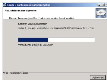
Nachdem Sie den „Funktionen auswählen Dialog“ mit „Weiter“ bestätigt haben führt der Installationsassistent eine Initialisierung durch. Das bedeutet alle benötigten Dateien werden zusammengestellt und temporär zwischengespeichert. Zur optischen Kontrolle wird Ihnen der Dialog „Aktualisieren des Systems“ angezeigt.
