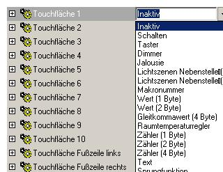
Auf der rechten Seite werden die Parameter der einzelnen Funktionen angezeigt. Es werden immer die Parameter der in der Mitte markierten Funktion angezeigt.
