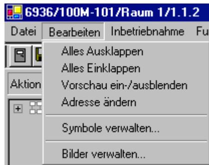
Wird aus dem Menü Bearbeiten die Funktion „Bilder verwalten...“ aufgerufen, öffnet sich ein Dialogfenster, mit dem Bilder in die Raumpanel Software importiert werden können.
