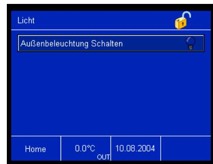
Auf der linken Seite der Touchfläche steht immer der „Name der Schaltfläche“. Dieser kann zu jeder Touchfläche mit dem entsprechenden Parameter frei vergeben werden.
