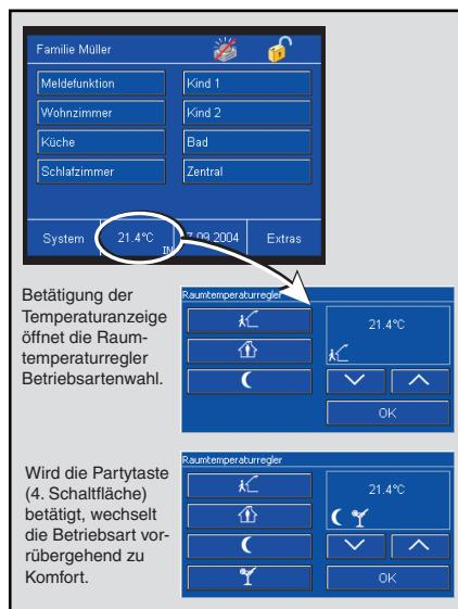
Das Raum-/Controlpanel hat einen integrierten Raumtemperaturregler. Dieser hat eine vergleichbare Funktionalität wie die übrigen EIB/KNX-Raumtemperaturregler.
