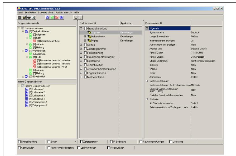
In der Mitte sind die Funktionen und Applikationen mit allen Kommunikationsobjekten angeordnet. Ggf. müssen die einzelnen Funktionen/Applikationen erst aktiviert werden, damit die Kommunikationsobjekte sichtbar werden. Die Funktionen werden über ein Pull-Down-Menü festgelegt.
