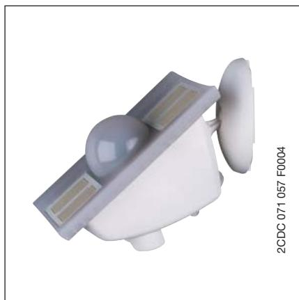
Der Wettersensor WES/A 1.1 dient – vorzugsweise im privaten Bereich. Zum Erfassen von Dämmerung (1...999 Lux), Helligkeit in drei Himmelsrichtungen (1.000...99.000 Lux), Regen (Obere und untere Sensorfläche werden permanent beheizt). Temperatur (-30...+ 50 °C), Tag/Nacht, Windgeschwindigkeiten (0...24,0 m/s), Datum und Uhrzeit (DCF Funkempfänger).
