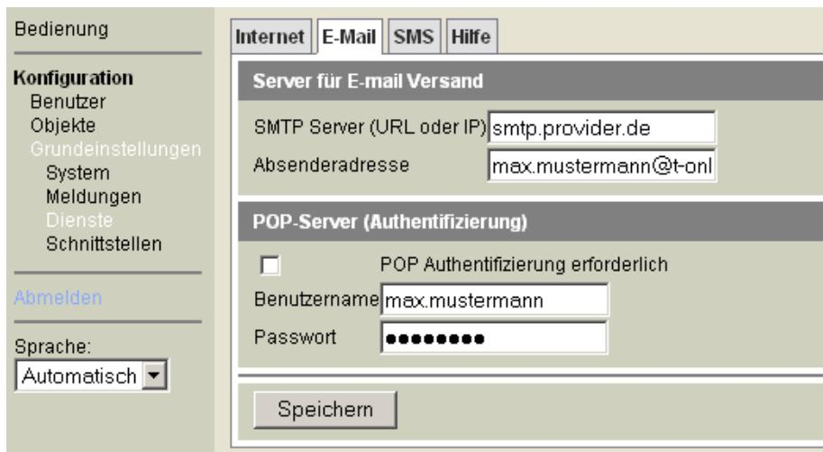
Hier befinden sich die Einstellungen, die benötigt werden, damit das Telefon-Gateway eine E-Mail versenden kann. Das Telefon-Gateway verwendet zum Datenaustausch mit dem Provider das standardisierte SMTP Protokoll.
