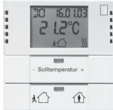
Mit dem Raumtemperaturregler mit 2fach Tastsensor besteht die Möglichkeit eine Einzelraumregelung zu realisieren und gleichzeitig Schalt-, Wert, Dimm-, Jalousiesteuerungs- oder Lüftungssteuerungstelegramme an KNX-Aktoren zu senden. Das Modul kann ebenfalls zur Lichtszenenspeicherung und/oder -aussendung genutzt werden.
