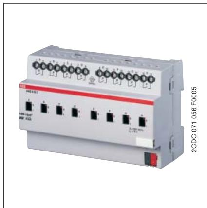
Die 16A-AC1-Schaltaktoren sind Reiheneinbaugeräte im proM Design für den Einbau in Verteiler auf einer 35 mm Tragschienen. Die Verbindung zum ABB i-bus® EIB / KNX erfolgt über Busanschlussklemme.
