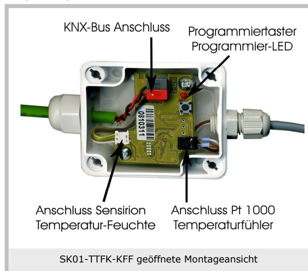
Der Deckel wird durch Drehen der Befestigungsschrauben um 90° gelöst.
