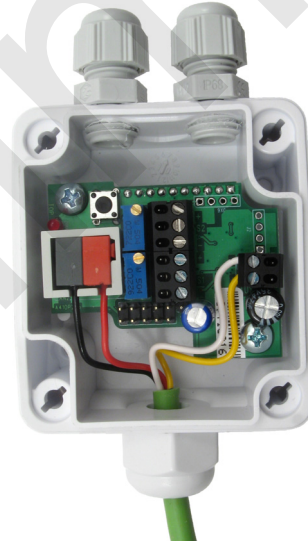
Bild 2: Angeschlossene Versorgungsspannung (9-30 V)
