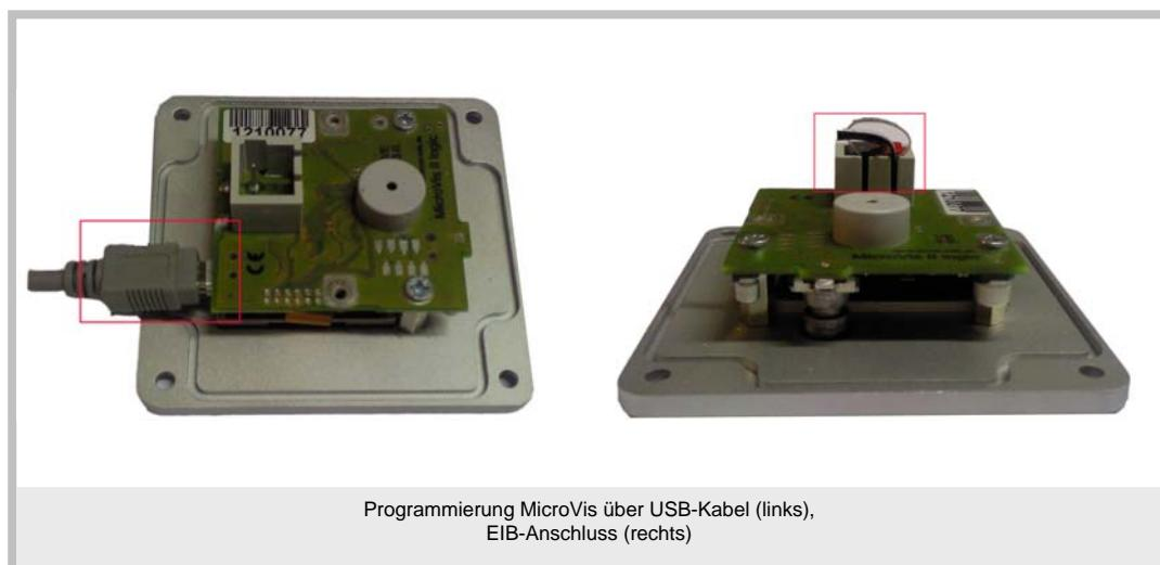
Das EIB-Kabel wird von Unten durch die Verschraubung direkt auf die Platine gesteckt. Das Display kann anschließend mit dem Gehäuse verschraubt werden.
