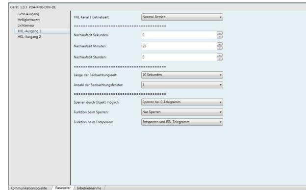
Der HKL-Kanal (Heizung, Klima, Lüftung) wurde so konzipiert, daß energieträchtige Anlagen zeitverzögert gestartet werden.
