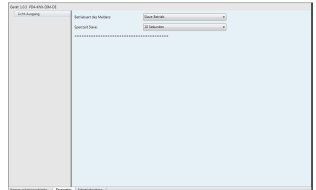
Die Sperrzeit ist der einzige Parameter der im Slavebetrieb parametrieren kann. Er gibt die Totzeit zwischen der Aussendung von zwei Signalen an.
