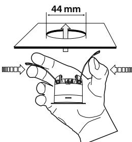
Der Melder wurde speziell für den Einbau in abgehängte Decken entwickelt. In der Decke muß zuerst eine runde Öffnung mit 44 mm erstellt werden.
