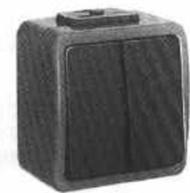
Die Gruppentaster-BA 2fach Ap ist eine Busankopplung kombiniert mit vier Mikrotastern und einer mechanischen Aufnahmeeinheit in neutraler Mittelstellung für Wippen. Integriert im AQUATEC Ap-Gehäuse wird die Schutzart IP 44 erreicht. Die Wippen gehören nicht zum Lieferumfang und können separat, je nach Anwendungsfall mit oder ohne Linse (Status-LED, Orientierungsleuchten), bestellt werden.
