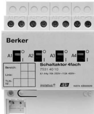
Der Schaltaktor empfängt Telegramme über den EIB und schaltet mit seinen vier potenzialfreien, voneinander unabhängigen Relaiskontakten Gruppen von elektrischen Verbrauchern. Die Schaltkontakte sind speziell für Lasten mit kapazitivem Charakter und dadurch für bedingt hohe Einschaltströme ausgelegt (siehe technische Daten).
