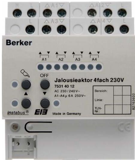
Der Jalousieaktor schaltet in Abhängigkeit von EIB-Telegrammen bis zu vier voneinander unabhängige Ausgangskanäle für jeweils einen Motor (4-kanal Betrieb). Auch ist es möglich, die Anzahl der Ausgangskanäle auf zwei zu reduzieren, sodass bis zu zwei Jalousiemotoren je Kanal angesteuert werden können (2 x 2-kanal Betrieb). In Abhängigkeit der allgemeinen Parametrierung können Jalousien oder Rollladen angesteuert werden.
