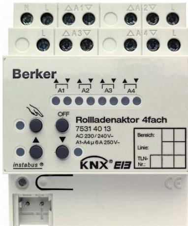
Der Rolladenaktor schaltet in Abhängigkeit von EIB-Telegrammen bis zu vier voneinander unabhängige Ausgangskanäle für jeweils einen Motor (4-kanal Betrieb). Auch ist es möglich, die Anzahl der Ausgangskanäle auf zwei zu reduzieren, sodass bis zu zwei Rolladenmotoren je Kanal angesteuert werden können (2 x 2-kanal Betrieb).
