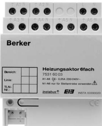
Der Heizungsaktor dient zur Ansteuerung von elektrothermischen Stellantrieben (ETA) für Heizanlagen oder Kühldecken. Er verfügt über 6 elektronische Ausgänge, die in Abhängigkeit von EIB-Telegrammen Stellantriebe geräuschlos ansteuern können.
