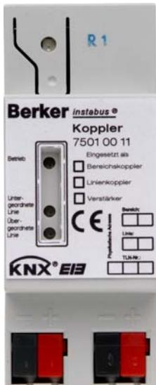
Der Bereichs-/Linienkoppler verbindet zwei instabus EIB Linien miteinander zu einem logischen Funktionsbereich und gewährleistet eine galvanische Trennung zwischen diesen Linien. Dadurch kann jede Buslinie einer EIB Installation elektrisch unabhängig von den anderen Linien betrieben werden.
