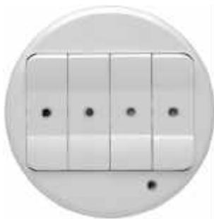
Das Anwendermodul zum Aufstecken auf die Up Busankopplung ermöglicht die Abspeicherung und den Abruf von bis zu acht Lichtszenen. Die Einstellung der Lichtszenen kann entweder mit Hilfe des Parameterfensters erfolgen oder durch separate Tastsensoren eingestellt werden. Nebenstellenbetrieb ist möglich. Den Betätigungsrippen ist eine LED als Kontrollfunktion zugeordnet, die Betriebs-LED zeigt die Funktionsbereitschaft an.
