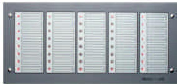
Zum Anschluss und passenden Einbau in Gehäuse Steuerelectronic (AP / Up) bzw. Steuermodul REG in Verbindung mit Spannungsversorgung 5V REG. Zeigt Status der Eingänge bzw. - Gruppenzustände an. Verbindung erfolgt über 20-poligen Parallelbus. Projektierung und Inbetriebnahme erfolgt über Programmiersystem EIBTAB. LEDs frei projektierbar. Moduladresse wird über Codierschalter eingestellt. LEDs betriebsbereit eingebaut. Bandkabel (30 cm) sowie Beschriftungsfelder im Lieferumfang enthalten.
