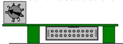
Am rückseitig angebrachten Codierschalter ist vor der Inbetriebnahme die der Planung mit EIBTAB entsprechende Adresse einzustellen (1 - F). In einem System dürfen nicht mehrere Frontplatten mit gleichen Adressen angeschlossen sein. Die Einstellung der Adresse 0 neutralisiert die entsprechende Frontplatte.
