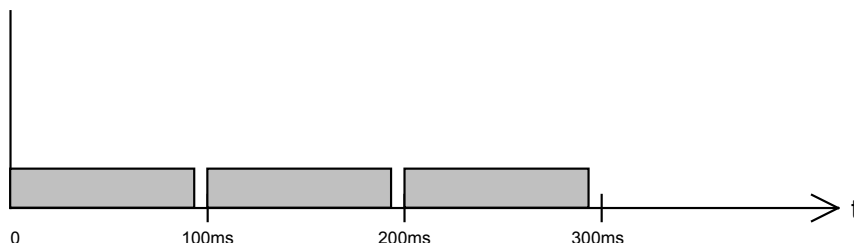
3.3.1.1 Bild: zyklischer Task mit Taskzykluszeit von 100 ms, Verarbeitungsdauer < 100ms
