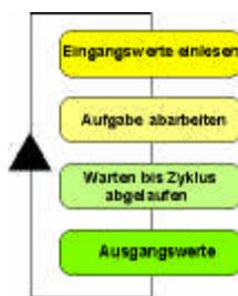
**Arbeitsweise und Taskzykluszeiten:** Die Funktionsmodule arbeiten nach den IPO-Prinzip (Input Processing Output). **Ein- und Ausgangspuffer** (50/100 Telegramme) sorgen für eine ordnungsgemäße Abarbeitung der Telegramme. Die Anwendung im FM (Applikation) besteht aus einer Gruppierung von Funktionsbausteinen, die wiederum in einzelne, logisch zusammenhängende Segmente eingegliedert werden. Diese Segmente werden einzeln oder in Gruppen sogenannten Tasks (Aufgaben) zugeordnet.
