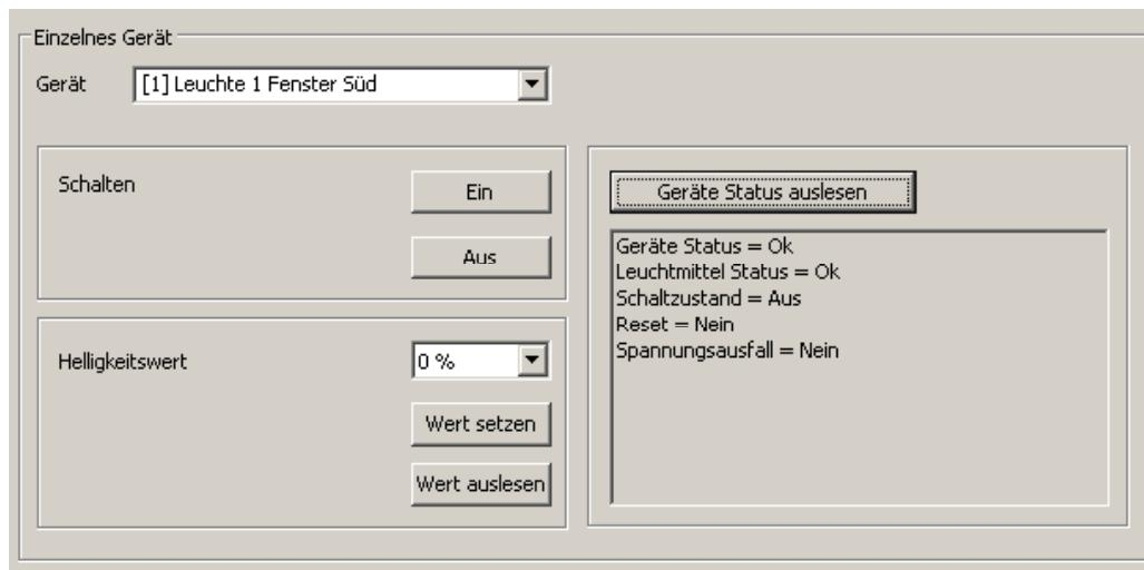
Bild 44: Geräteorientierte DALI-Testumgebung
