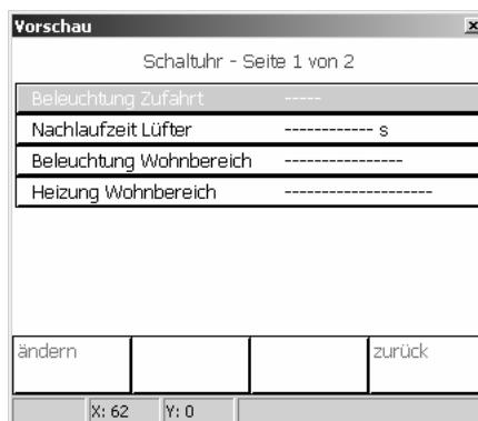
Jedem Kanal können 8 Schaltzeiten zugeordnet werden. Die Wochentage zu jeder Schaltzeit sind frei wählbar. Die Programmierung der Schaltzeiten der Kanäle erfolgt nach der Projektierung direkt am Tableau über die Schaltuhrseite.
