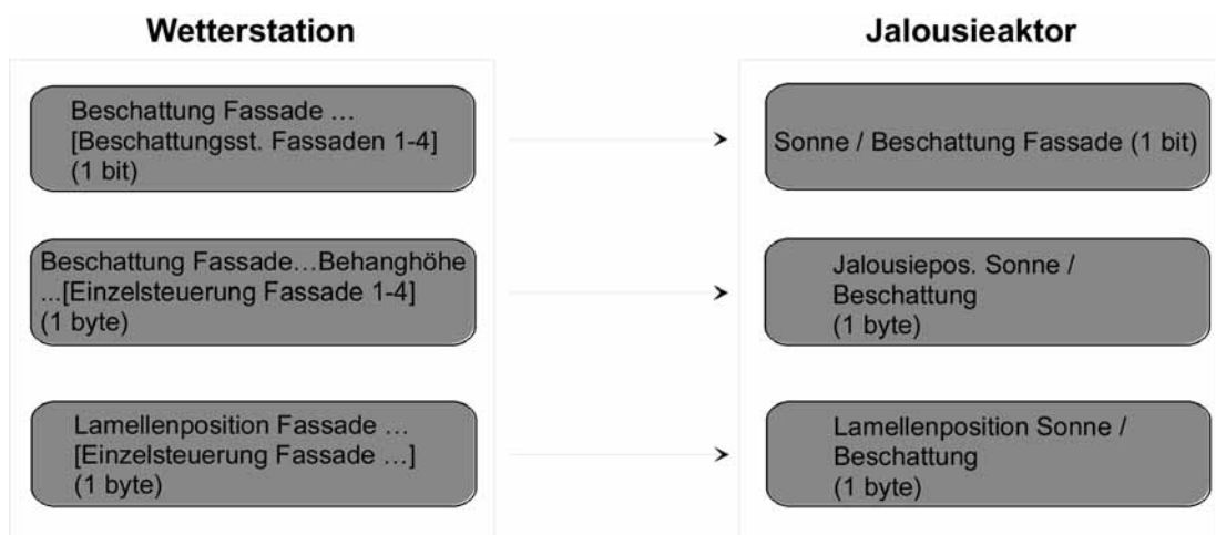
Bild 28: Projektierung der Kommunikationsobjekte für Anwendungsbeispiel IV.
