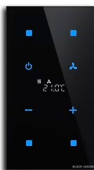
Bedienelement mit vier Symbolen und Raumtemperaturregler
