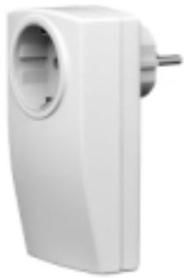
Der Powernet - Zwischenstecker - Schaltaktor dient zum geschalteten Betrieb von Leuchten mit Schuko- / Eurostecker. Die Bedienung erfolgt über separate Powernet EIB Sensoren.
