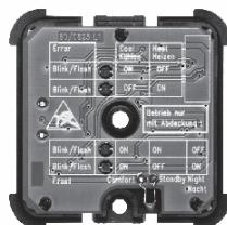
Das Anwendungsmodul Raumtemperaturregler für Objektbereich wird auf einen Busankoppler UP oder einem 5fach Binäreingang UP aufgesetzt.
