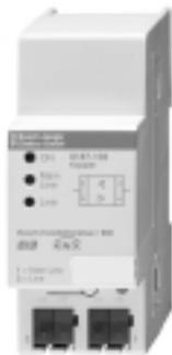
Der Koppler kann als Linien-/Bereichskoppler oder als Linienvorstärker eingesetzt werden. Als Linienkoppler verbindet er eine Linie mit einer Hauptlinie. Als Bereichskoppler verbindet er eine Hauptlinie mit der Bereichslinie. Hierbei sorgt er für eine galvanische Trennung.
